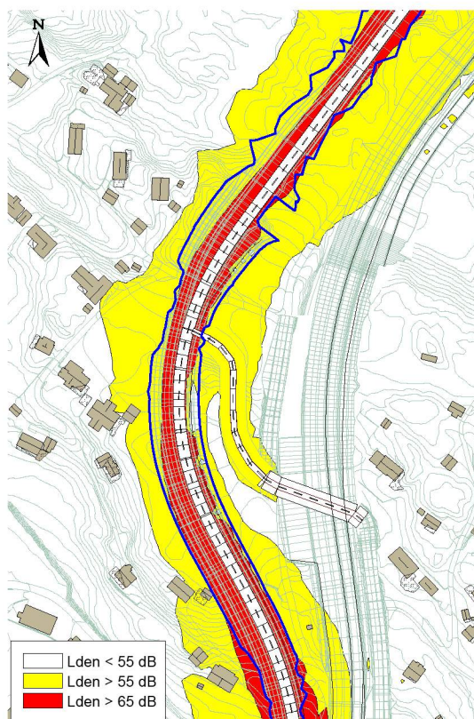
Figur 11: Støy fra ny lokalveg alternativ A, byggetrinn 2.
