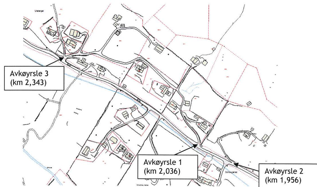
Bakgrunnen for søknaden er svært dårlig sikt i avkørysle 1. Ingen av dei to aktuelle avkøyrlene oppfyller dagens krav til teknisk utforming. Sikta er aller dårligast i avkørysle 1, medan avkørysle 2 er den som i størst grad avvik fra krav til geometrisk utforming.
