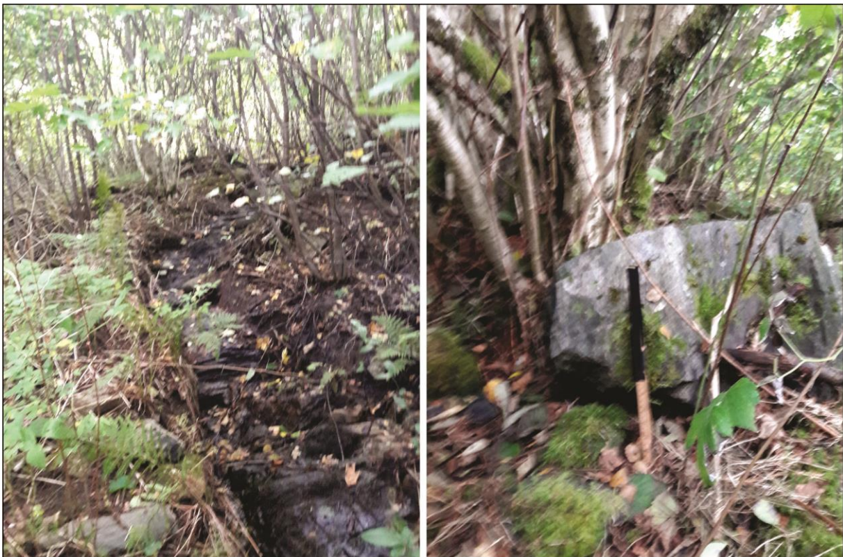
Figur 4: Skråninga aust for planområdet er prega av eit tynt torvlag over fast fjell. Det er observert fleire blokker som støttar seg til trea.
