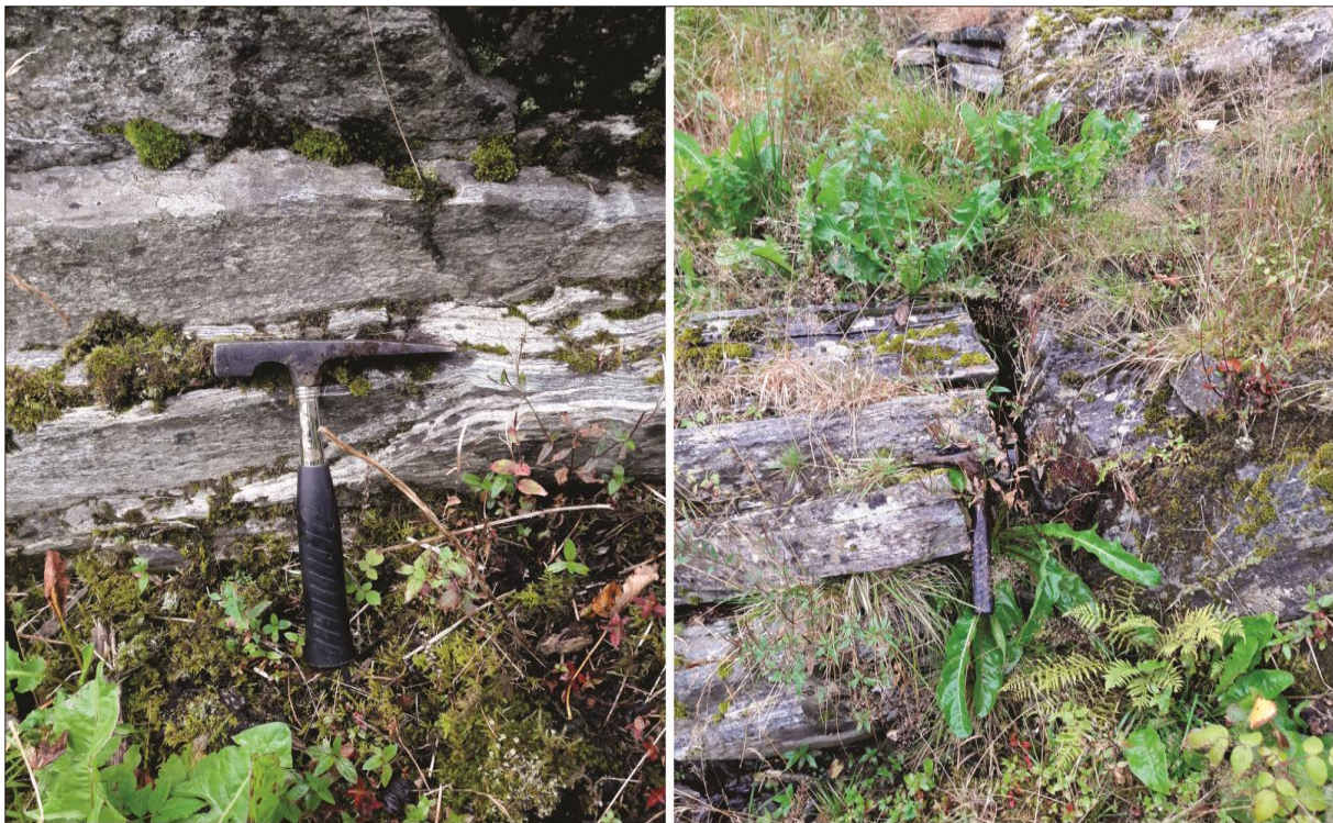
Figur 6: Bergarten er gneis som har foliasjon omtrent normalt på skråninga. Bergarten sprekk opp langs foliasjonen og fører til flate blokker som ligg i skråninga.
