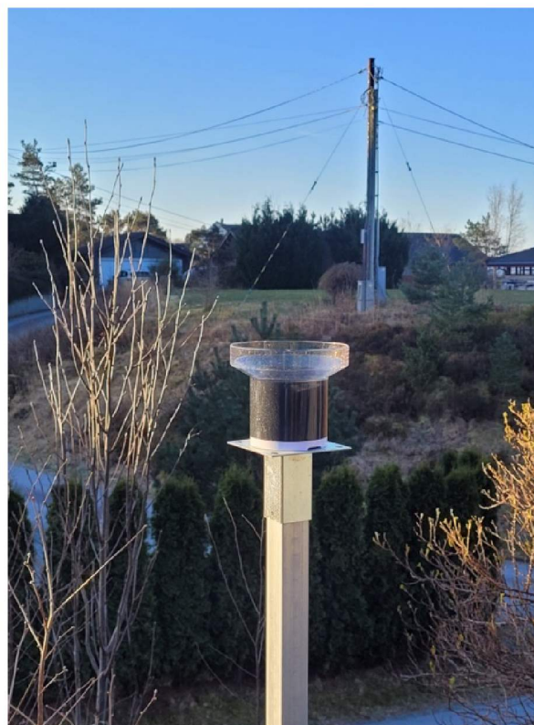
Figur 1: NetAtmo regnmåler plassert i hage med god avstand til bygninger og trer.
