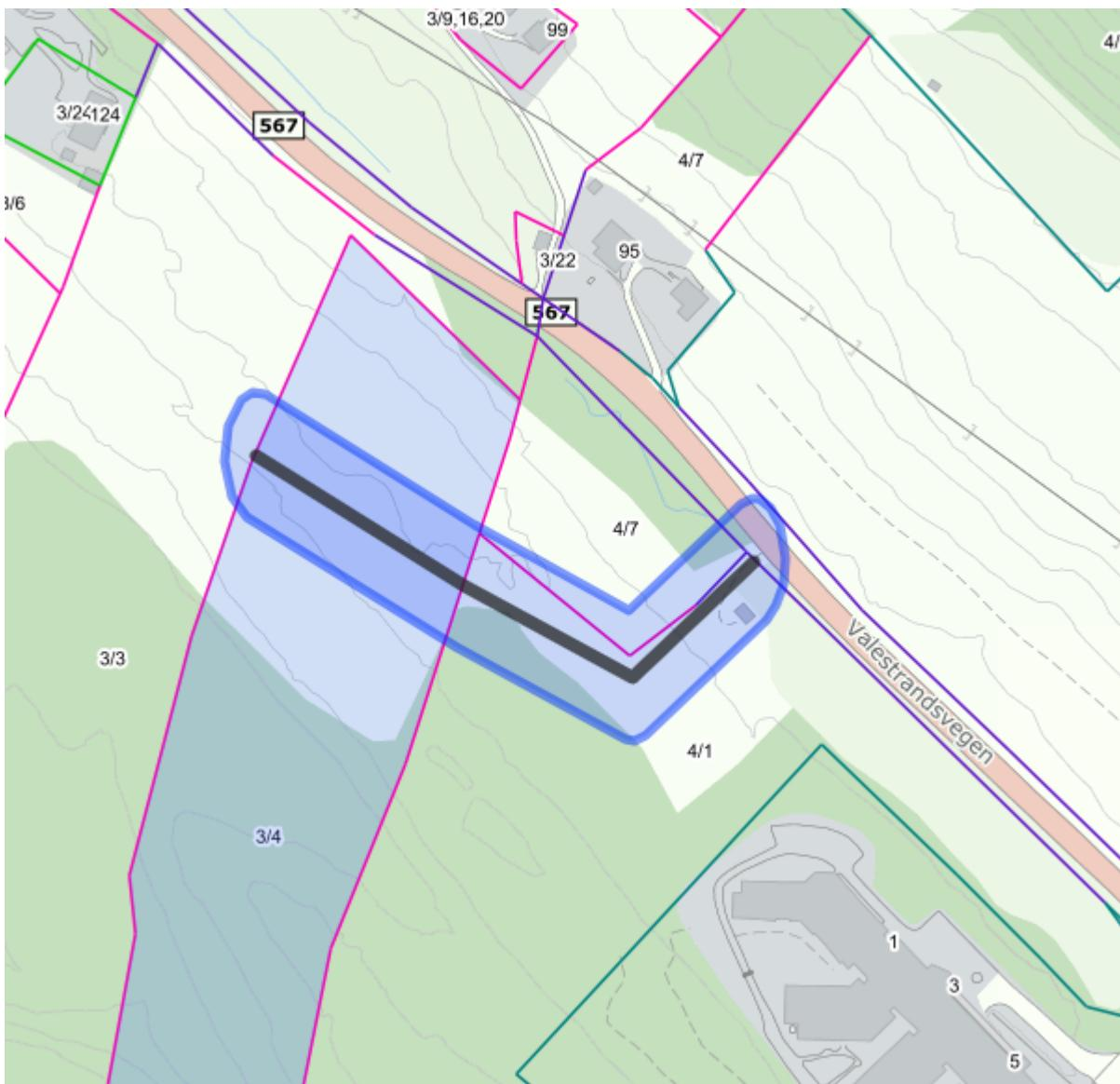
Vegen skal gå i eit tidlegare traktor-slep og treng lite opparbeiding, den vil krysse steingarden mellom gnr. 3 og 4 det steingard er fjerna tidlegare, og har ei lengd på om lag 200 meter. Denne vegen treng så lite opparbeiding at den knapt treng sokjast.
