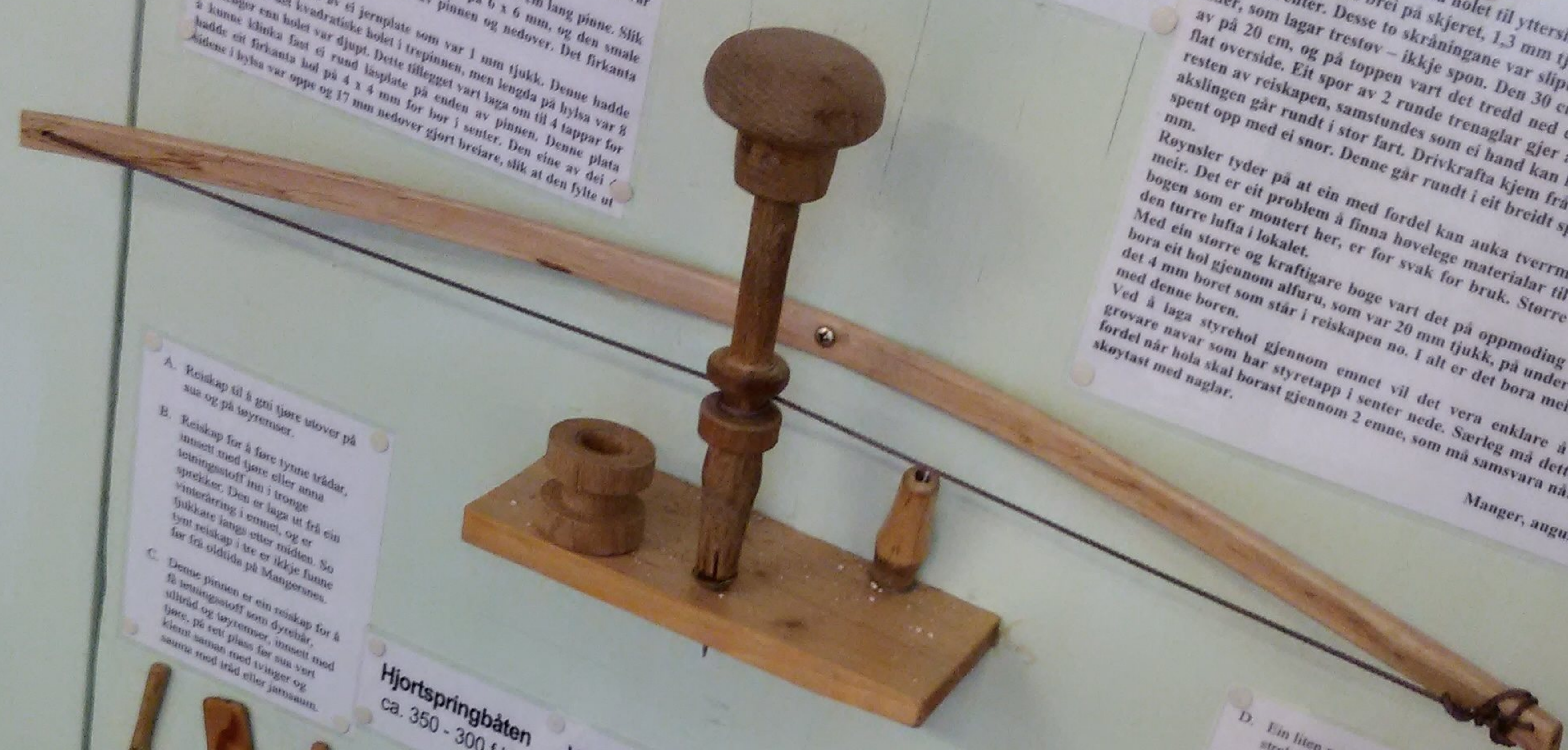
Fig. 26. Smedkerarbeide i det gamle Ægypten. Boring med Buesnor.
