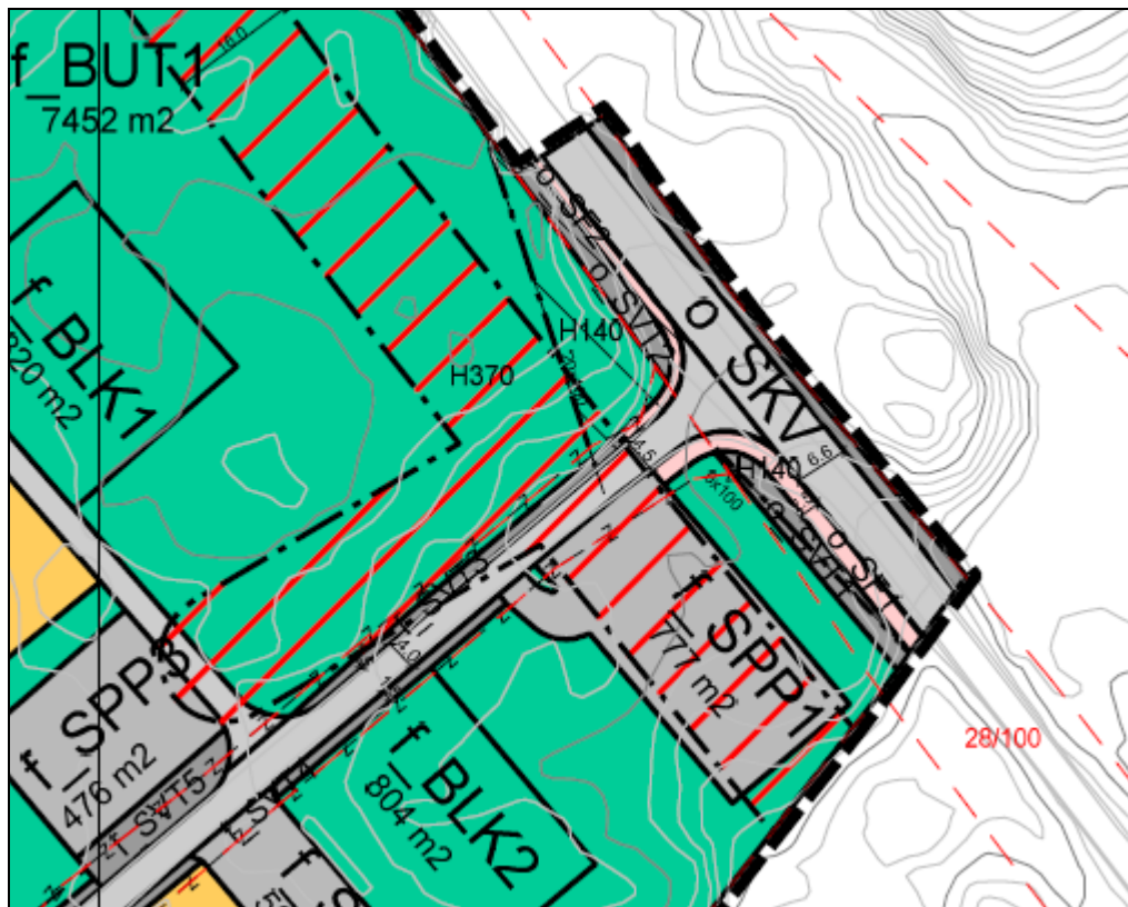
Figur 25: Utsnitt frå plankart syner regulert situasjon med breidder og frisiktsoner i krysset til Fv141.
