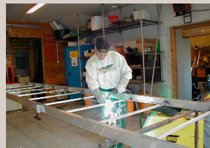
Rampe av aluminium under arbeid.
