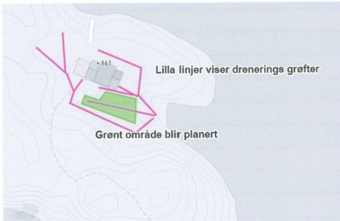
Figur 29: Illustrasjon over dreneringsgrøfter og område som vil bli planert. Merk at det er ingen høydekoder i området vi ønsker å planere, dette er kun mindre terrengendringer.
